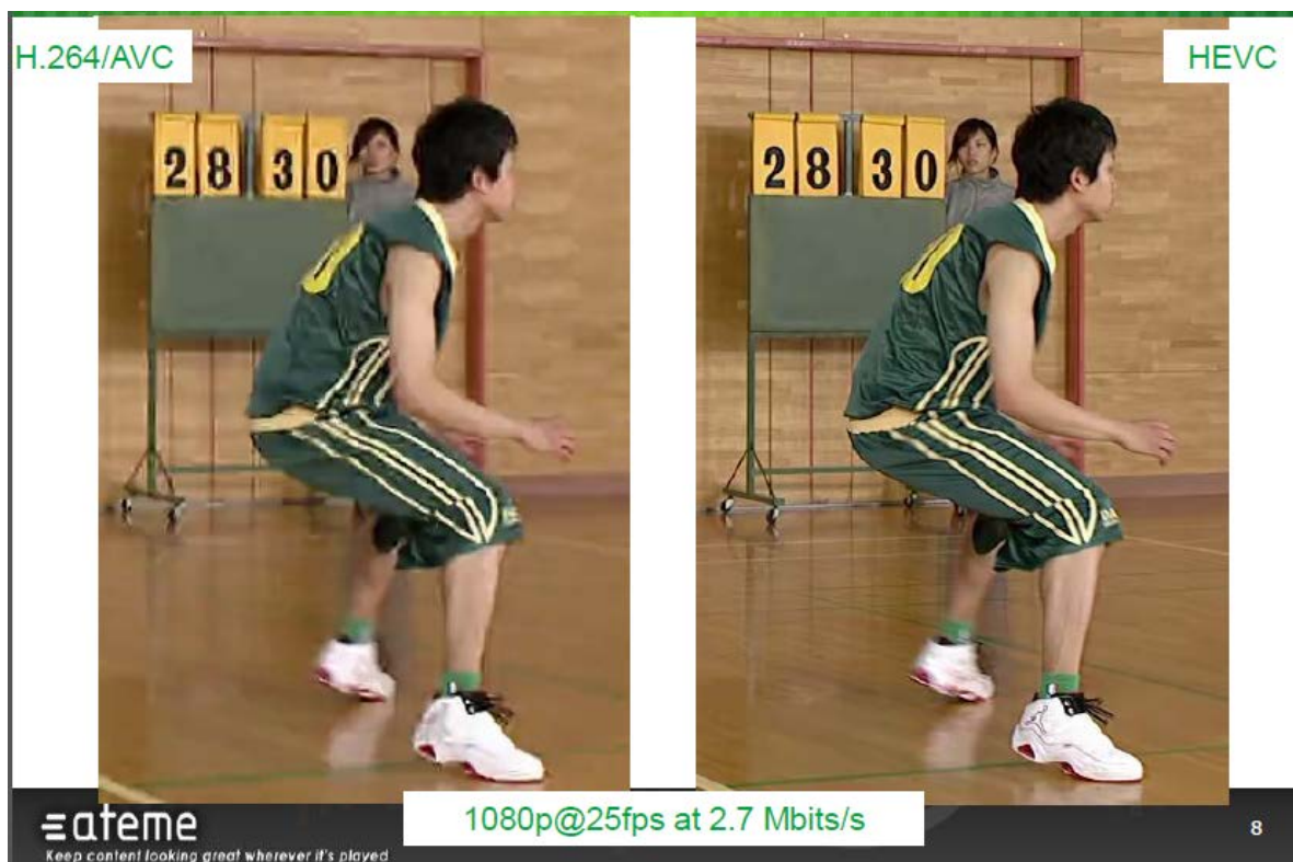
รูปที่ ๒ เปรียบเทียบการแสดงผลภาพระหว่างการเข้ารหัสภาพแบบ H.264/AVC และ HEVC
