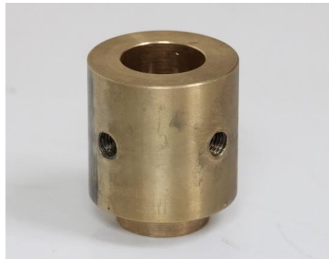
รูปที่ 9 แสดง (ซ้าย) การกลึงตัวยึดท่อเพื่อให้ได้ขนาดที่ต้องการ (ขวา) หลังจากเสร็จเรียบร้อยแล้ว
