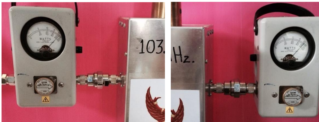
รูปที่ 18 แสดงการวัดกำลัง (ซ้าย) ก่อนเข้าวงจรกรองวัดได้ 440 วัตต์ (ขวา) หลังผ่านวงจรกรองวัดได้ 410 วัตต์
