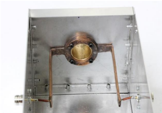
รูปที่ 10 แสดง (ซ้าย) การยึดขดลวดเข้ากับตัวยึดท่อ (ขวา) แสดงตัวเก็บประจุที่ปลายท่อทองแดงด้านล่าง
