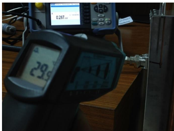
รูปที่ 13 แสดงการวัดอุณหภูมิขณะทำการส่งผ่านกำลังความถี่วิทยุ 500 วัตต์ (แต่เหลือแค่ 287 วัตต์ เนื่องจากเปิดฝาล่อง)
