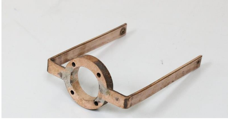
รูปที่ 8 แสดงการเชื่อมต่อขดลวดขาเข้า-ออก เข้ากับส่วนที่ยึดกับกล่อง
