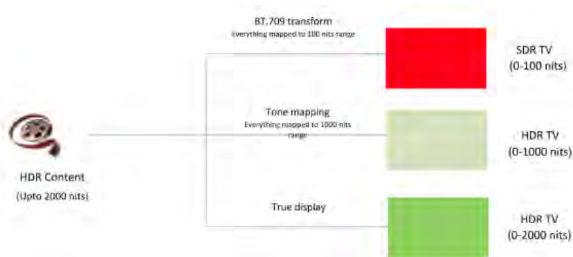
รูปที่ 7 ผลลัพธ์เมื่อมีการนำภาพไปแสดงบนโทรทัศน์ที่มีความสามารถแตกต่างกัน
