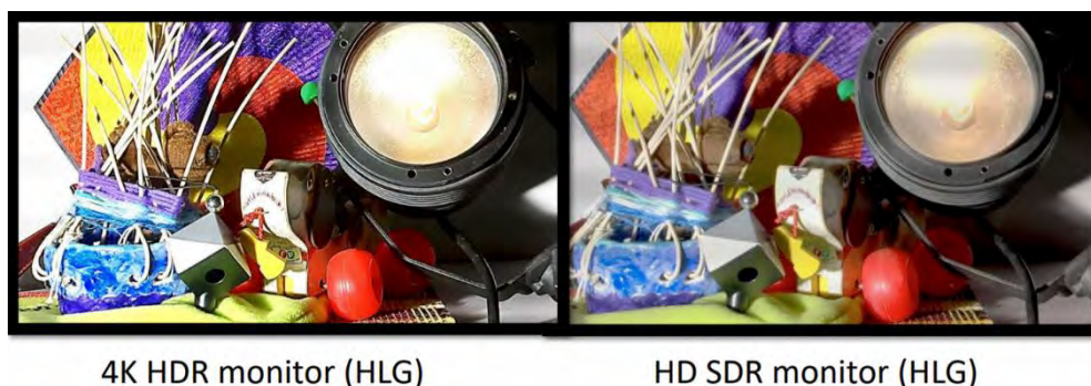
รูปที่ 22 ภาพแสดงการรองรับเทคโนโลยี HLG มาแสดงบนโทรทัศน์ที่รองรับเทคโนโลยี SDR ที่มา: https://www.venerattech.com/hdr-transfer-functions-hlg-pq/
