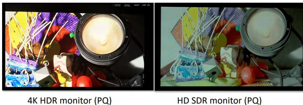
รูปที่ 21 ภาพแสดงการรองรับเทคโนโลยี PQ มาแสดงบนโทรทัศน์ที่รองรับเทคโนโลยี SDR ที่มา: https://www.venerattech.com/hdr-transfer-functions-hlg-pq/
