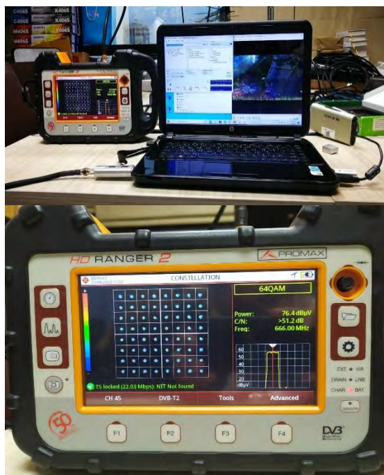
รูปที่ 79 การทดลองทดสอบออกอากาศโทรทัศน์ภาคพื้นดินฯ ด้วยเทคโนโลยี 4K ผ่านสายนำสัญญาณ
