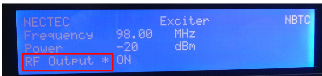
รูปที่ 13 เมื่อกดด้านล่างของ membrane switch ลงมาจนกระทั่ง * จะเลื่อนมาที่ช่อง RF
