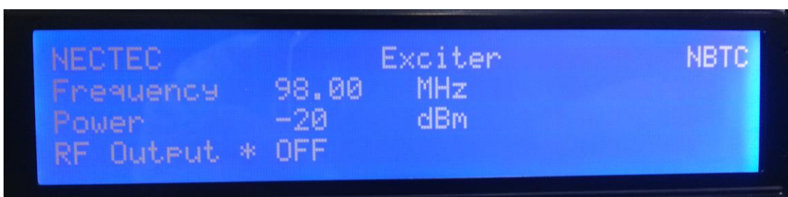
รูปที่ 15 กดด้านซ้ายของ membrane switch เพื่อเป็นการเลือก ON/OFF
