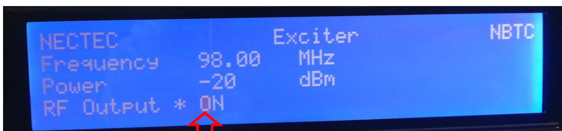
รูปที่ 14 เมื่อกดด้านขวาของ membrane switch จะมี cursor กระพริบขึ้นมา เพื่อรอการเปิดหรือปิดสัญญาณ RF
