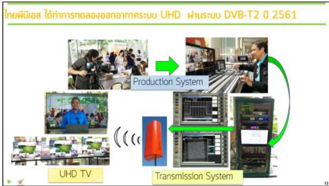
รูปที่ 6 ไดอะแกรมขั้นตอนการทดลองทดสอบการออกอากาศโทรทัศน์ฯ ด้วยเทคโนโลยี 4K ที่มา: องค์การกระจายเสียงและแพร่ภาพสาธารณะแห่งประเทศไทย (ไทยพีบีเอส)
